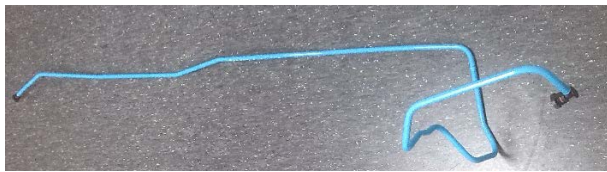
Abbildung 1: Kraftstoffleitung aus Kunststoff
