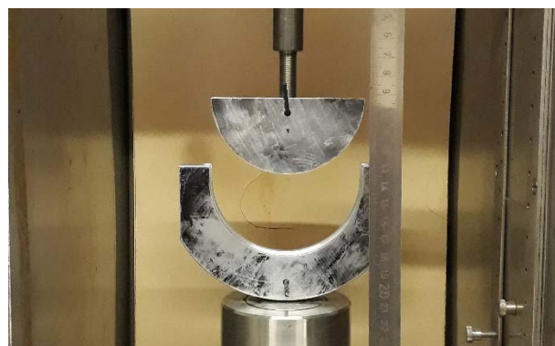
Abbildung 3: Aufbau für vereinfachte 180°-Rohrbiegung
