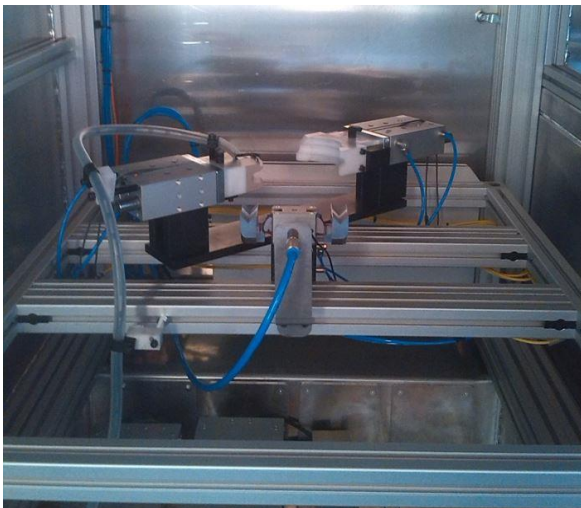
Abb. 3: Aktuelle Biege zelle von mobitec mit einer Arbeitsfrequenz von 13.56 MHz
