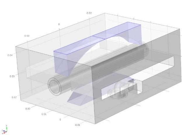
Abb. 1: Mikrowellenresonator für Kunststoff-Biege Zwecke entw. mit COMSOL
