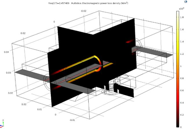
Abb. 2: Berechnete dielektrische Verluste im zu bearbeitenden Kunststoffrohr
